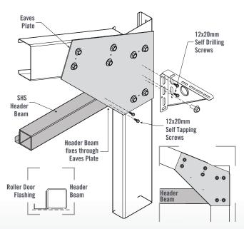
**ROLLER DOOR HEADER BEAM ATTACHMENT- ALTERNATIVE PITCH** FIGURE 42
