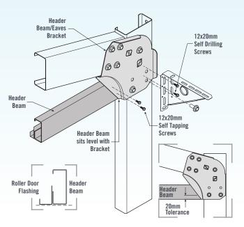
ROLLER DOOR HEADER BEAM ATTACHMENT- 15° PITCH
